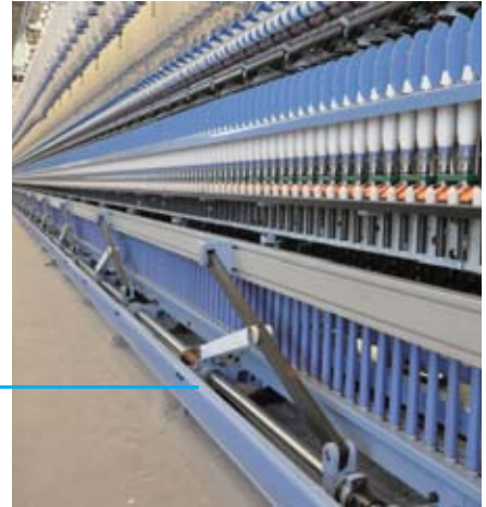
CSB-LIN 应用于细纱机集体落纱装置 CSB-LIN for spinning machinery
