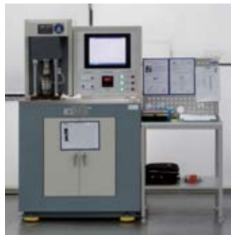
端面摩擦磨损试验机 Washer test machine
